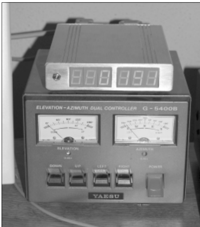
Obr. 5 – Hotový interfejs na ovládacej skrínke k rotátoru Yaesu G-5400.
