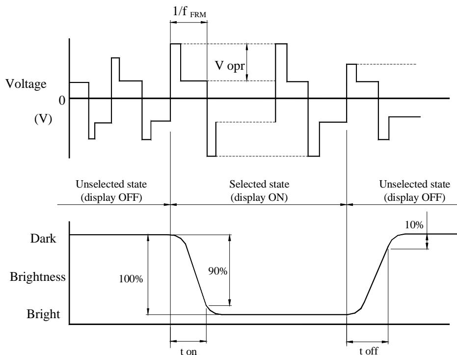
$V_{opr}$  : Operating voltage (V)
